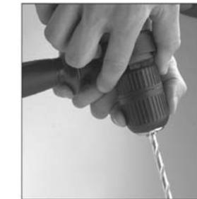
1) Ослабьте муфту быстрозажимного патрона, установите сверло в патрон, крепко затяните муфту зажимного патрона по часовой стрелке. Если в процессе работы муфта ослабляется, затяните ее сильнее.
