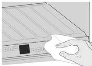
**При отключении устройства на длительный срок** выключите его и выньте вилку шнура питания из сетевой розетки или выверните предохранитель. Во избежание появления неприятного запаха вымойте винный шкаф и оставьте дверь открытой.
