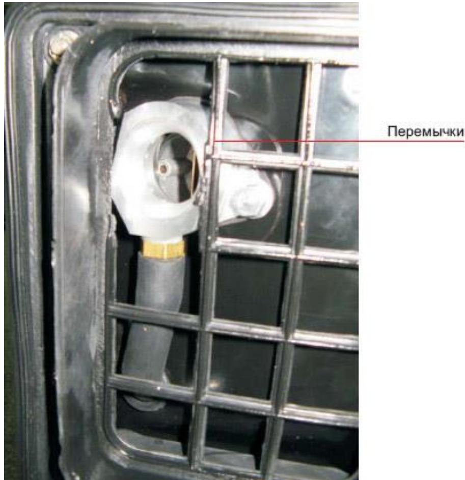
9. Вырезать часть перемычек из решетки воздушного фильтра
