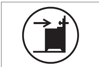
1. Установите кронштейн защиты от опрокидывания, воспользовавшись круглым отверстием в нем и отступив на 317-322 мм вниз от верхнего края прибора и на 80-85 мм от бокового края прибора. Как следует привинтите его к твердому надежному материалу или прикрепите с помощью соответствующей арматуры к стене.
