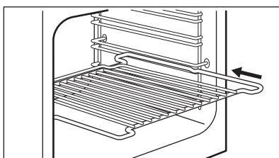
Вставьте полку между направляющими планками духового шкафа. Двусторонние кромки должны быть расположены в задней части духового шкафа по направлению вверх.
