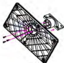
4. Приложите собранную подставку к телевизору и зафиксируйте ее с помощью четырех винтов M4x10.
