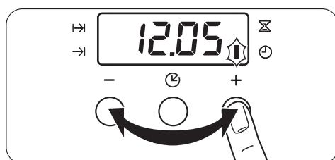
Cihazı elektrik şebekesine bağladığınızda veya bir elektrik kesintisi sonrasında Saat fonksiyonu yanıp söner.
