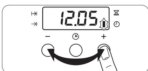
При первом включении прибора в сеть или при сбое электропитания начинает мигать символ времени суток. С помощью «+» или «-» установите текущее время суток. Примерно через пять секунд мигание прекратится, и на дисплее отобразится установленное время суток.
