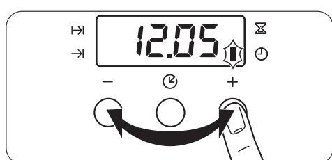
Құрылғыны токқа қосқаннан кейін немесе тоқ сөнгеннен кейін таймер функциясының индикаторы жыпылықтайды.
