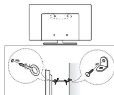
1 Вставьте и затяните болты с ушками или болты кронштейнов ТВ на задней панели телевизора.
