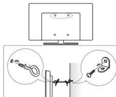
1 Introduceți și strângeți șuruburile cu ureche sau suporturile și șuruburile televizorului pe spatele televizorului.
