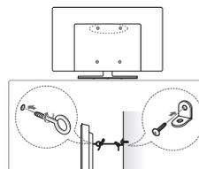
1 Вставьте и затяните болты с ушками или болты кронштейнов ТВ на задней панели телевизора.
