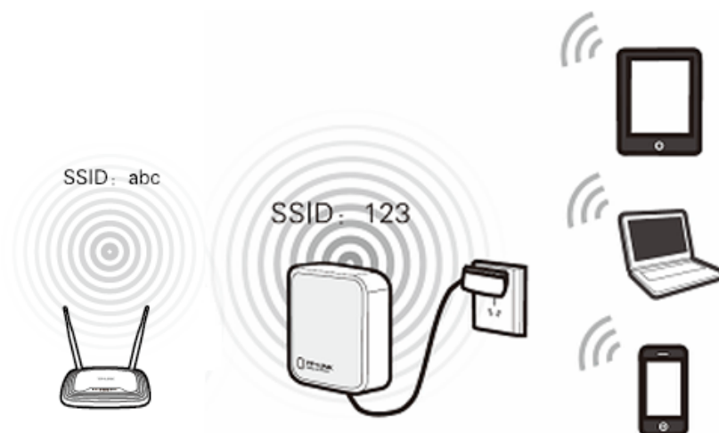
Рисунок 2-4 Установка TL-WR702N в режиме моста
