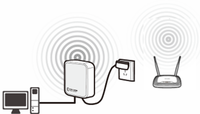
Рисунок 2-5 Установка TL-WR702N в режиме клиента
