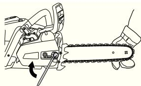
При установки новой цепи следует часто проверять ее натяжение , пока цепь не приработается. Регулярно проверяйте натяжение цепи. Регулярно проверяйте натяжение цепи. Правильно натянутая цепь обеспечивает высокое качество пилиния и дальше служит.
