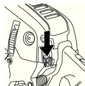
**ПОМНИТЕ!** Выключатель Запуск/Остановка автоматически переходит рабочее положение. В целях избежания непроизвольного запуска, головка свечи должна быть всегда снята со свечи при сборке, проверке и/или обслуживании.
