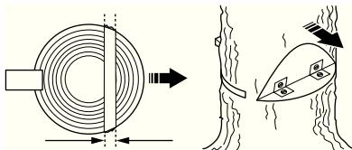
Возможность влияния на направление падения будет полностью утрачена, если полоса разлома слишком узкая или пропилована направляющий и основной пропилы плохо размещены.
