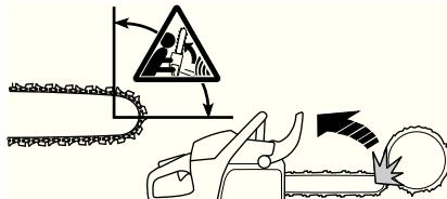
Резка нижней кромкой полотна, т.е. от поверхности объекта к нижнему краю известна как пиление с нажимом. В этом случае моторная пила сама наезжает на дерево и передний край моторной пилы соответствует естественному положению при резке. Пиление с нажимом обеспечивает лучший контроль над моторной пилой и расположением области отдачи.
