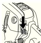
Остановка двигателя осуществляется нажатием на выключатель запуска/остановки.
