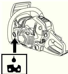
Топливный фильтр следует менять по крайней мере один раз в год. Загрязнение баков может привести к сбоям в работе. Перед заправкой убедитесь, что топливная смесь была хорошо перемешана, для этого взболтайте емкость с топливом. Объемы баков для топливной смеси и масла цепи соответствуют друг другу. Поэтому при заправке топлива обязательно заливайте масло для смазки цепи.
