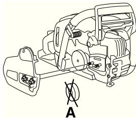
Установите пильное полотно на специально предназначенные болты. Установите полотно в самое заднее положение. Оденьте цепь на ведущую звездочку и вставьте ее хвостовики в паз пильного полотна. Начинайте с верхней стороны пильного полотна.
