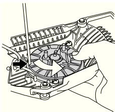
Снимите зажим в центре шкива. Снимите распорную втулку и шкив. Вставьте и натяните на шкиве новый шнур стартера. Намотайте примерно 3 оборота шнура на шкив. Соберите шкив стартера с возвратной пружиной так, чтобы пружина упиралась в шкив. Установите распорную втулку и закрепите шкив с помощью зажима. Пропустите шнур стартера через отверстие в корпусе и ручке стартера. Сделайте узел на шнуре стартера.
