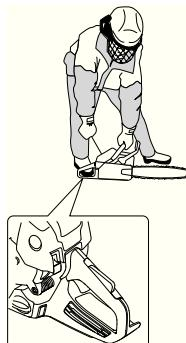
Так как тормоз цепи по-прежнему включен, двигатель должен как можно скорее быть переведен на холостые обороты, что может быть достигнуто за счет быстрого выключения ограничителя газа. Тем самым Вы избежите ненужного износа сцепления, барабана сцепления и тормозной ленты.
