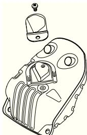
Глушитель служит для снижения уровня шума и отвода раскаленных выхлопных газов от рабочего. Выхлопные газы очень горячие и
