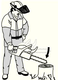
При прикосновении пильного полотна к пню должен сработать тормоз.
