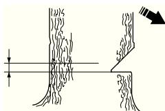
Вставьте зубчатый упор (если установлен) сзади надреза. Работайте на полном газу и вводите пильное полотно в ствол дерева постепенно, плавным движением. Следите за тем, чтобы дерево не начало перемещаться в направлении, противоположном предполагаемому направлению падения. Как только пропил станет достаточно глубоким, загоните в него клин или вагу.
