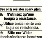
Всегда используйте только указанный тип свечи! Применение несоответствующей модели может привести к серьезным повреждениям поршня/цилиндра.
