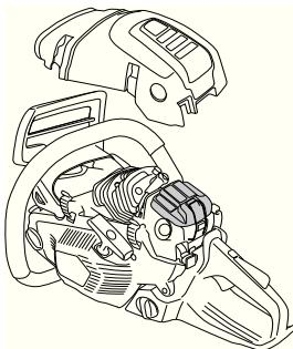
Для более тщательной чистки фильтр следует помыть в воде с мылом.
