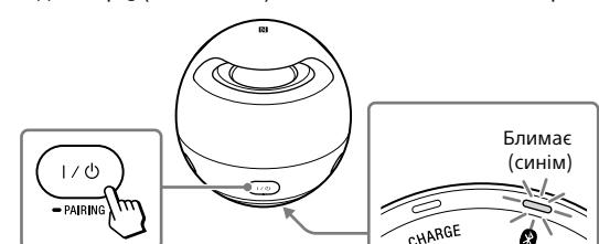
Установіть з'єднання, виконуючи вказівки на екрані. Після встановлення з'єднання BLUETOOTH індикатор **❶ (BLUETOOTH)** на системі продовжує світитися. Щоб скасувати встановлене з'єднання, торкніться смартфоном системи ще раз.
