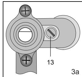
13 Регуляционный винт для минимальной тепловой нагрузки
