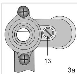
13 Регуляционный винт для минимальной тепловой нагрузки
