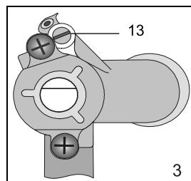
13 Регулировочный винт для минимальной тепловой нагрузки
