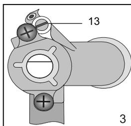
13 Регулировочный винт для минимальной тепловой нагрузки
