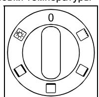
Ручка включения/выключения и выбора режима работы духовки (зависит от модели)
