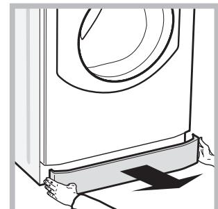
1. Çıkarana kadar ilk önce ortaya doğru bastırarak ve her iki yanından iterek makinenin önündeki kapak panelini çıkarın(*şekile bakınız*);
