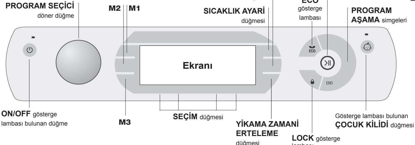
① ON/OFF gösterge lambası bulunan düğme: Makineyi açıp, kapamak için bu düğmeye bir süre basın. Yeşil gösterge lambası makinenin açık olduğunu gösterir. Program sırasında, çamaşır makinesini kapatmak için, yaklaşık 3 saniye düğmeyi basılı tutun, düğmeye bir süre veya istemeden basılırsa, makine kapanmayacaktır. Program sırasında makine kapatılırsa, bu program iptal edilecektir.
