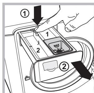
Çekmeceyi çıkarmak için, kola(1) basın ve çekmeceyi (2) dışarı doğru çekin (*şekile bakınız*).
