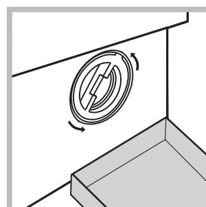
2. Akan suyu toplamak için bir kap yerleştirin (yaklaşık 1.5 l) (*şekile bakınız*);
