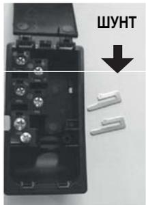
проводников шнура питания на длине 10 мм, принимая в расчет длину шнура питания, необходимую для выполнения соединений на клеммной колодке. Выполните подключения проводников и шунтов (были сняты в предыдущей операции) в соответствии с типом линии электропитания, как показано в представленной ниже таблице.<sup>1</sup> Установите крышку. Затяните винты зажима шнура питания.
