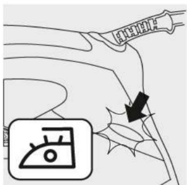
Дождитесь, пока погаснет индикатор нагрева утюга. Это означает достижение утюгом установленной оптимальной температуры.
