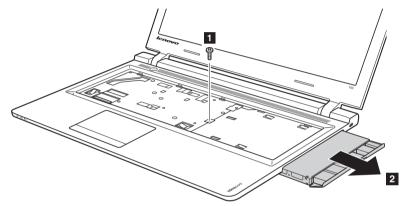
Выньте винт 3, а затем выньте держатель оптического привода в направлении, указанном стрелкой 4.
