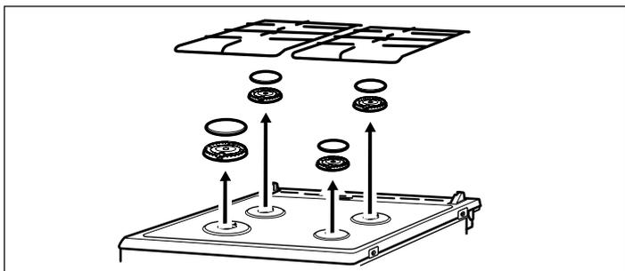
3. При наличии винтов крепления горелок снимите их полностью с варочной панели.
