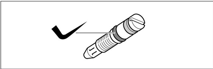
4. Установите и туго затяните новые регулировочные винты. Убедитесь в том, что все регулировочные винты установлены на соответствующих запорных кранах.
