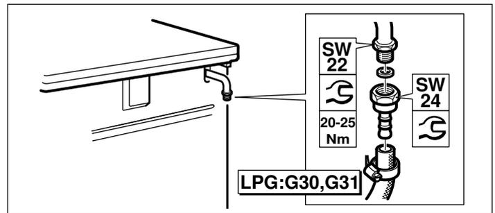
3. Наденьте специальный безопасный шланг и зафиксируйте с помощью резьбового соединения или шлангового хомута.
