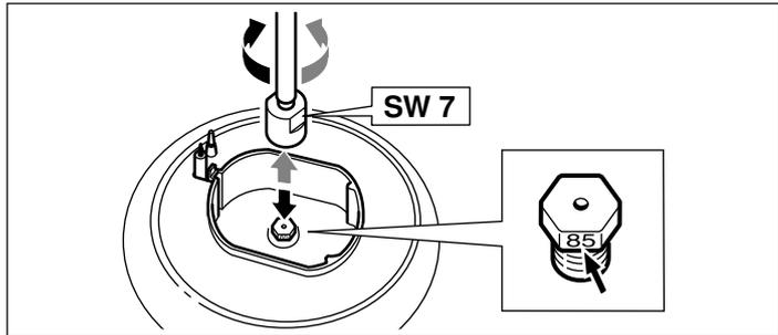
5. Если ваш прибор оснащён горелкой Wok с боковым доступом, снимите форсунку горелки как показано ниже (с помощью шестигранного ключа с раствором на 7 мм)
