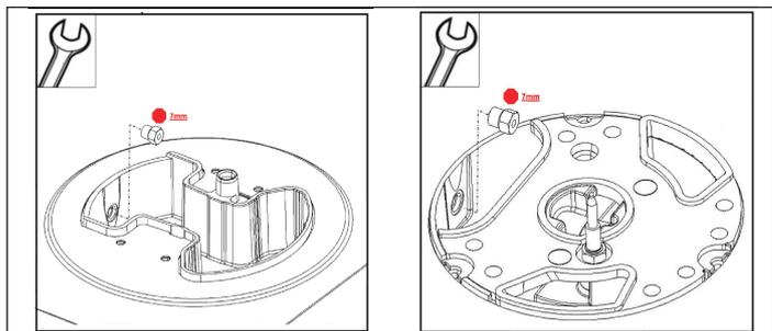
6. Определите форсунки горелок по таблице. Для этого см. главу «Технические характеристики – газ».
