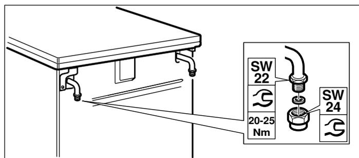
**Указание:** При выполнении подключения прибора следует использовать динамометрический ключ.
