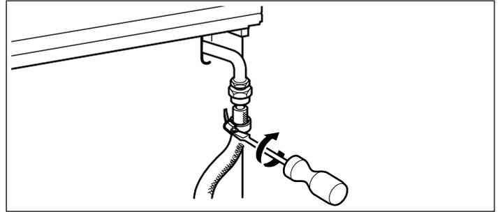
4. Для выполнения проверки герметичности см. указания в разделе "Проверка герметичности". Откройте подачу газа.
