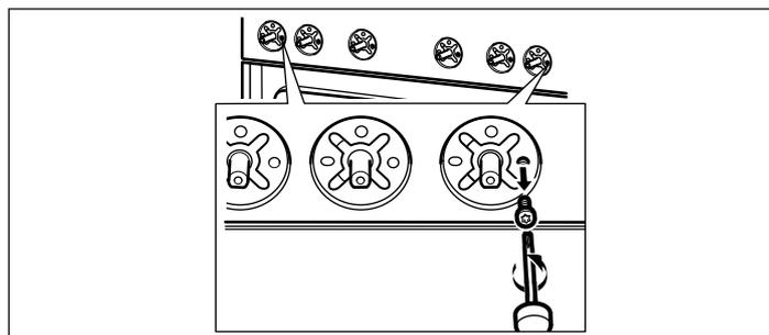
9. Возьмитесь двумя руками за фронтальную панель и медленно оттяните её вверх. Выньте панель из крепёжных скоб, после чего осторожно снимите её движением вперёд. Следите за тем, чтобы не повредить кабели и не отсоединить подключения.
