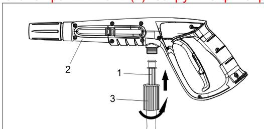
Подключите шланг подачи воды в отверстие водозабора.
