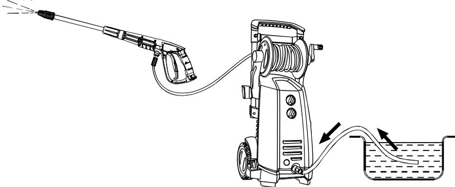
**Внимание:** 1. Во время использования функции самовсасывания конец водозаборного шланга должен быть погружен в воду.
