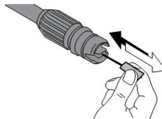
**ВАЖНО:** Чистящий инструмент можно использовать только в том случае, если направляющая трубка распылителя отсоединена!
