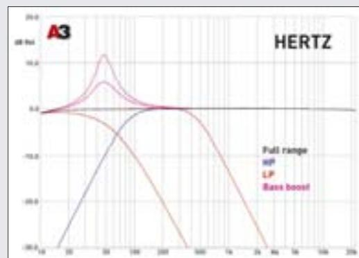
АЧХ фильтра НЧ довольно (хотя и не абсолютно) стабильная: крутизна -12 дБ/окт. сохраняется в диапазоне перестройки (48 — 500 Гц), добротность чуть меняется. ФВЧ — фиксированный, сказано 80 Гц — сделано 80 Гц. Характеристика — классическая, Баттерворт второго порядка. Буст даёт штатный подъём, но на более низкой (около 47 Гц) частоте.
