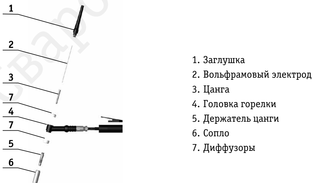
Рисунок 7.2.1 Основные компоненты горелки TIG
