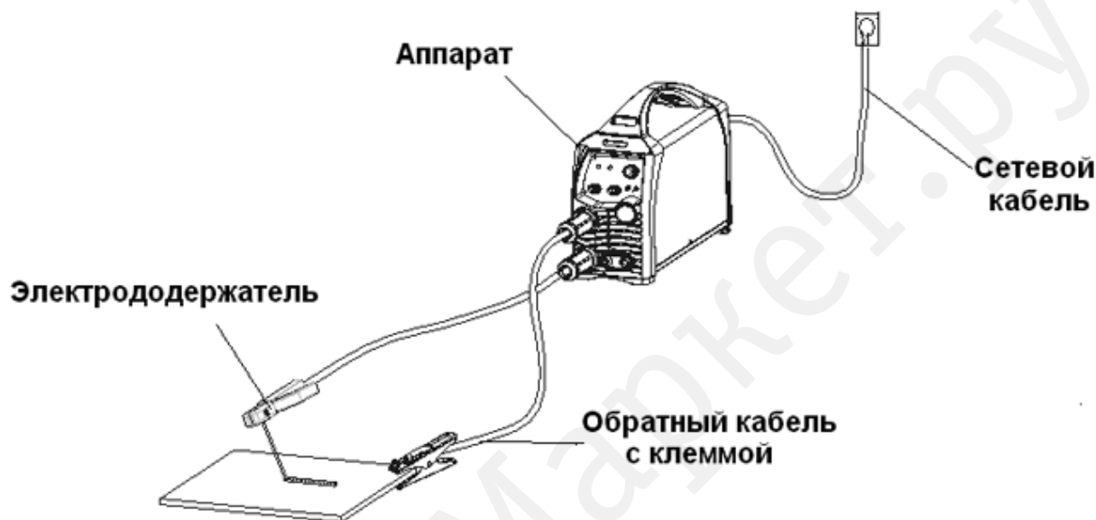
Рисунок 6.3 Схема подключения оборудования для ММА сварки.
