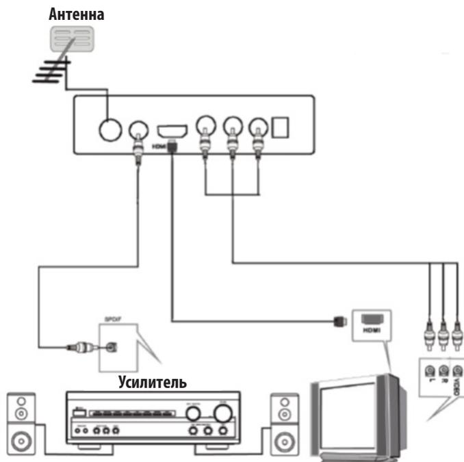
Подключите к проигрывателю телевизор в соответствии со схемой выше. Это необходимо сделать до начала работы с прибором.
