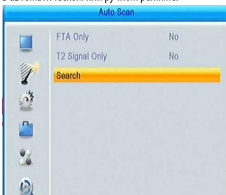
Для автоматической настройки стрелками выберите пункт Auto Scan и нажмите кнопку OK для входа в режим настройки. Режим FTA Only (Free-To-Air) позволяет вам выбрать для настройки только бесплатные каналы – для этого режима переведите установите значение YES, или платные и бесплатные каналы – для этого режима установите значение NO. Режим T2 Signal Only – позволяет устройству настраиваться только на цифровые (значение YES) или цифровые и аналоговые (значение NO) каналы.
