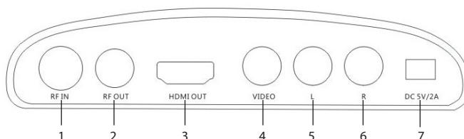
1. Вход RF IN для подключения внешней ТВ антенны
