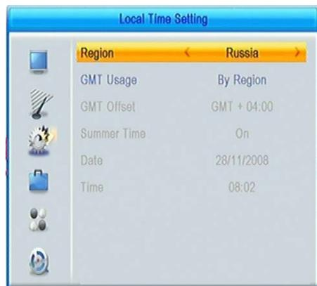
В подменю Local Time Setting (Настройка времени) установите регион, в котором вы будете использовать устройство. В режиме автоматической установки времени (GMT Usage – By Region) устройство само выставит нужные настройки, вы сможете изменить их вручную при необходимости.
