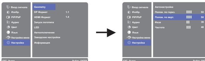
Заново нажмите кнопку ② на мониторе или кнопку ENTER на пульте дистанционного управления. Для изменения установок экранного вертикального положения используйте кнопки ▲ / ▼. С каждым нажатием на клавиши будет изменяться положение по вертикалам.
