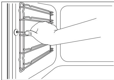
2. Вытяните заднюю часть направляющей из боковой стенки и снимите ее.
