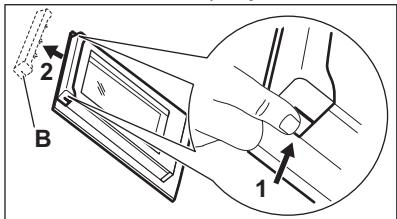
7. Чтобы снять дверную планку, потянните ее вперед.
