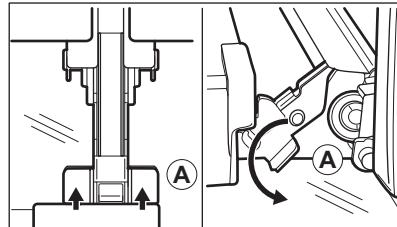
3. Прикройте дверцу до первого фиксируемого положения (приблизительно на угол 70°).
