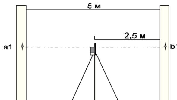
Установить лазерный построитель плоскостей на расстоянии 0,5-0,7м от стены и нанести, как указано выше, те же отметки. Если разности {a1-a2} и {b1-b2} не отличаются друг от друга более чем на величину „точность”, заявленную в технических характеристиках, точность Вашего лазерного построителя в допустимых пределах.
