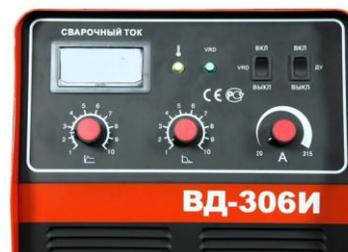
Режим VRD: Включает встроенный блок снижения холостого хода. Этот режим необходим для проведения сварочных работ во влажных условиях. В обычном режиме, напряжение холостого хода составляет 72В. Но при повышенной опасности поражения сварочным током, режим VRD переводит аппарат в режим, снижающий напряжение холостого хода до 13В. Данная функция рекомендуется для монтажных высотных работ, проведения сварочных работ на судостроительных верфях, работах в климатических зонах с повышенной влажностью.
