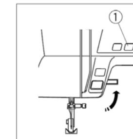
Поднимите прижимную лапку. Нажмите кнопку поднимания/опускания иглы ① чтобы поднять рычаг нитеводителя в верхнее положение.
