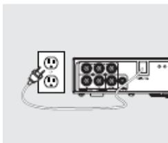
Один конец сетевого шнура питания подключите к входному разъему питания на задней стенке проигрывателя, а вилку сетевого шнура питания подсоедините к электрической розетке.
