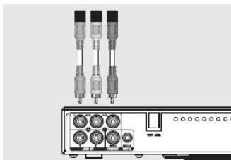
Если подключаемый телевизор оборудован компонентным видеовыходом, рекомендуется использовать этот тип подключения, т.к. он обеспечивает максимальное качество изображения.
