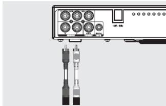
С помощью аудиокабеля RCA, поставляемого в комплекте, соедините аудиовыход проигрывателя с аудиовыходом телевизора или другого устройства.
