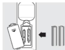
Откройте крышку отсека для элементов питания. Установите два новых элемента питания типа ААА. Установите крышку на место до щелчка. При установке элементов питания соблюдайте полярность (+) и (-).
