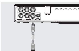
С помощью композитного видеокабеля (в комплект поставки не входит) соедините видеовыход проигрывателя (VIDEO OUT) с видеовыходом телевизора.
