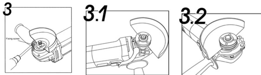
► Установите защитный кожух так, чтобы исключался выброс искр в направление оператора.
