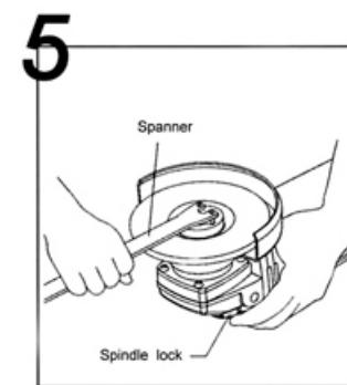
**Внимание!** Кнопка стопорного вала используется только для установки и демонтажа диска. Не используйте ее в качестве аварийной кнопки, когда работает электроинструмент. В противном случае это может привести к поломке инструмента или нанесению телесных повреждений.
