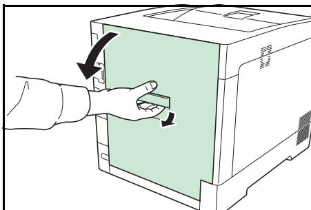
**1** Потянув ручку задней крышки вверх, откройте заднюю крышку.
