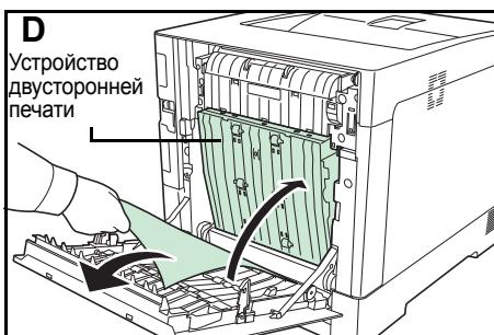
Если бумага застряла внутри устройства двусторонней печати, как показано на рисунке **D**, поднимите устройство двусторонней печати и удалите бумагу.
