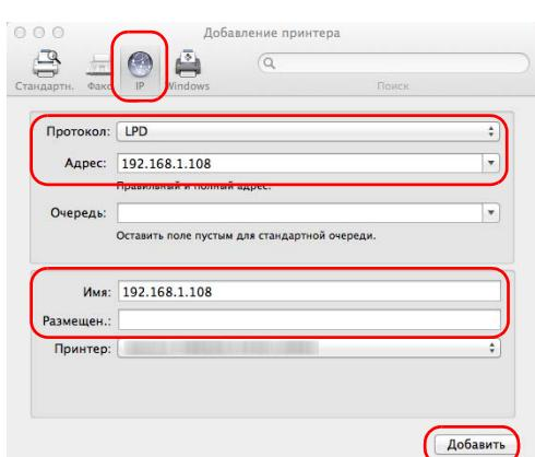
**9** Щелкните пиктограмму IP для IP-подключения и введите IP-адрес и имя принтера.
