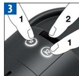
W celu wydłużenia okresu wyłączania automatycznego automatycznego wyłączenia z 9 do 30 minut: Wyłączyć urządzenie, wcisnąć jednocześnie przyciski Espresso i Lungo a następnie wcisnąć przycisk ON/OFF.
