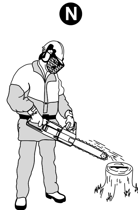
Рисунок N — проверка работы устройства автоматической смазки пильной цепи.
