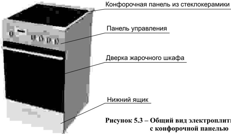
Рисунок 5.3 – Общий вид электроплиты с конфорочной панелью из стеклокерамики
