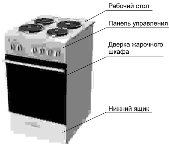
**Рисунок 5.1 - Общий вид электроплиты**
