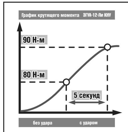
**Примечание!** При заворачивании не выключайте изделие сразу при упоре крепежного элемента в деталь; при отворачивании ждите не менее указанного времени до начала отворачивания.
