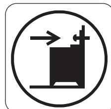
1. Захист від перекидання потрібно встановити на відстані 317–322 мм від верхньої поверхні приладу та 80–85 мм збоку від приладу у круглий отвір на скобі. Прикрутіть його до твердої поверхні або використайте відповідне кріплення (стіну).
