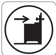
1. Установите кронштейн защиты от опрокидывания, воспользовавшись круглым отверстием в нем и отступив на 317-322 мм вниз от верхнего края прибора и на 80-85 мм - от бокового края прибора. Как следует привинтите его к твердому надежному материалу или прикрепите с помощью соответствующей арматуры к стене.
