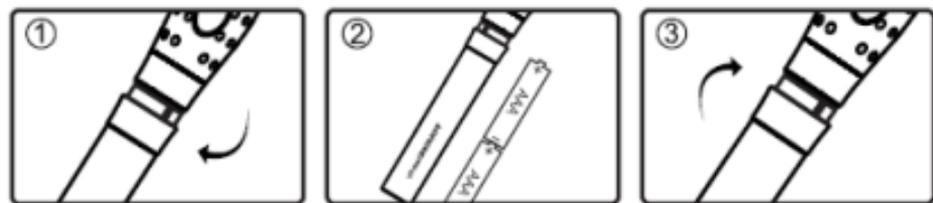
Поверните отсек питания, как показано на рисунке, чтобы его открыть. Установите внутрь две новые батарейки с соблюдением полярности и закройте батарейный отсек.
