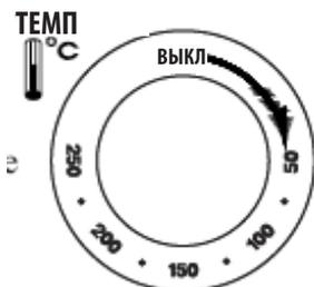
Регулятор температуры устанавливает температуру, до которой будет нагреваться камера печи. Рабочий диапазон составляет от  $+50^{\circ}\text{C}$  до  $+250^{\circ}\text{C}$ . Для установки промежуточных значений температуры следует ориентироваться на равномерность шкалы температур. Например, для установки температуры  $+75^{\circ}\text{C}$  следует расположить указатель регулятора посередине между значениями  $+50^{\circ}\text{C}$  и  $+100^{\circ}\text{C}$ .
