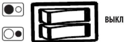
Верхний переключатель предназначен для включения/выключения правой конфорки.
