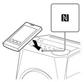
Выполните соединение в соответствии с инструкциями, отображаемыми на смартфоне. После установки соединения ВLUETOOTH индикатор ВLUETOOTH перестанет мигать и будет гореть постоянно. На дисплее появится название устройства BLUETOOTH.
