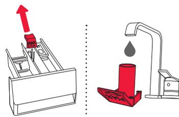
**3** При необходимости снимите и очистите **колпачок дозатора**.
