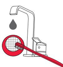
**2** Тщательно промойте **фильтр под проточной водой**.
