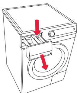
**1** Дозатор можно **полностью извлечь из корпуса**, нажав на язычок.
