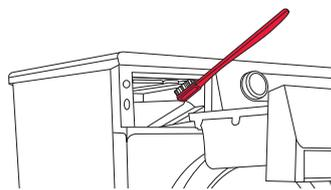
**2** Очистите отсек дозатора, особенно **форсунки в верхней части отсека**, щеткой.
