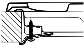
Монтаж крюка для опорных брусков H= 40 мм
