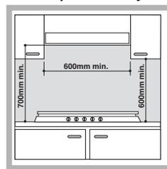
Если варочная панель устанавливается под навесным шкафом, последний должен располагаться на высоте не менее 700 мм от кухонного топа (см. рисунок).
