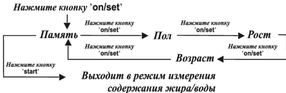
Для установки обычного режима контроля процентного отношения жира необходимо нажать кнопку "Start" (Пуск).
