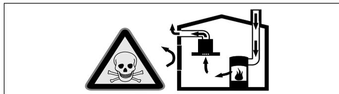
Источники пламени с подводом воздуха из помещения (например, работающие на газе, жидком топливе, дровах или угле нагреватели, проточные водонагреватели, бойлеры) получают воздух для сжигания топлива из помещения, где они установлены, а отработавшие газы отходят через вытяжную систему (например, вытяжную трубу) из помещения на улицу.
