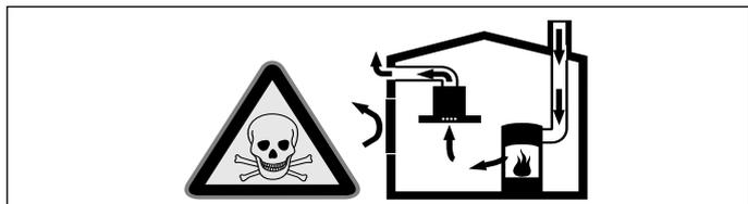
Источники пламени с подводом воздуха из помещения (например, работающие на газе, жидком топливе, дровах или угле нагреватели, проточные водонагреватели, бойлеры) получают воздух для сжигания топлива из помещения, где они установлены, а отработавшие газы отходят через вытяжную систему (например, вытяжную трубу) из помещения на улицу.
