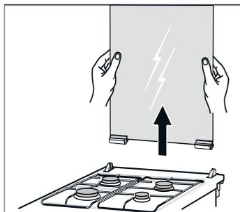
Если нужно снять и крепления крышки, обратите внимание на буквы на них. Крепление с буквой «R» должно быть установлено справа, крепление с буквой «L» - слева.
