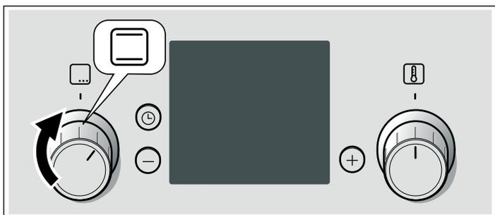
2. Регулятором температуры можно установить температуру или режим гриля.
