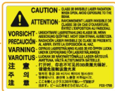
Лазерный луч может быть опасен для здоровья человека. Поскольку излучение, испускаемое внутри данного изделия, полностью заключено в защитные корпуса и внешние панели, лазерный луч не может выйти из аппарата наружу ни на одном этапе своего рабочего цикла. Не снимайте защитные корпуса или внешние панели, кроме случаев, предусмотренных в руководствах по эксплуатации данного оборудования. Для обеспечения безопасности прочитайте следующие заметки и инструкции.
