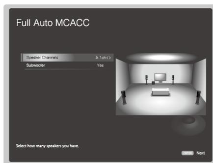
Изображение на экране зависит от числа каналов, указанного в "Speaker Channels", и его следует использовать в процессе настройки. На этом экране также указывается наличие или отсутствие подключенного сабвуфера.
