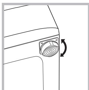
2. Якщо підлога не ідеально горизонтальна, компенсуйте нерівності за допомогою передніх ніжок (див. малюнок) – розкручуючи чи закручуючи їх; кут нахилу відносно робочої поверхні не повинен перевищувати 2°.
