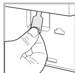
4. За допомогою вказаного на малюнку язичка тягніть пластмасову тягу з упору назовні, аж доки її не буде звільнено; потім протягніть її донизу, одночасно відкриваючи дверцята.
