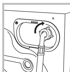
2. Підключіть шланг подачі води до пральної машини, під'єднавши його до водорозбірного крану, який знаходитьться угорі праворуч на задньому боці машини (див. малюнок).
