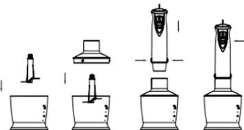
1. Установите насадку-измельчитель на штырь внутри емкости для нарезки, нажмите на насадку так, чтобы раздался щелчок, означающий, что насадка надежно зафиксирована. Всегда устанавливайте емкость для нарезки на нескользящую поверхность.
