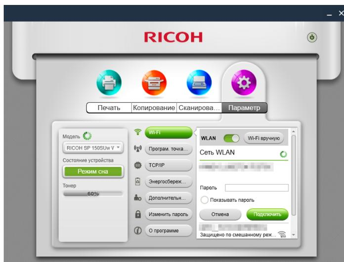
Переключайте переключатель WLAN для включения и отключения Wi-Fi. Принтер необходимо перезагрузить, чтобы изменения настроек Wi-Fi вступили в силу.
