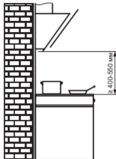
При наличии в комнате печи, газового котла или колонки необходимо учитывать, что во время работы вытяжка забирает из помещения воздух, необходимый для горения. Это относится также к помещению с герметичными окнами и дверями.
