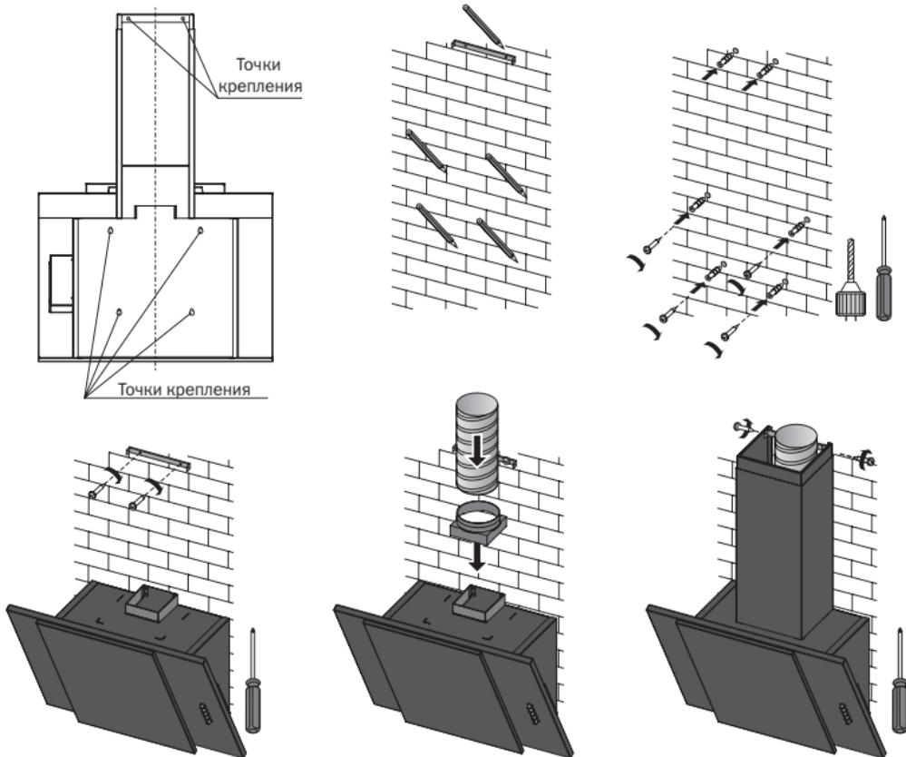
1. Прикрепите вытяжку задней поверхностью к стене при помощи саморезов с дюбелями из монтажного комплекта.
