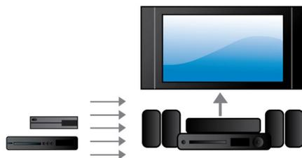
Оцените невероятное качество изображения 3D и кристально чистый 5.1- или 7.1-канальный звук. Для этого нужно лишь подключить выход x2 HDMI к разъему A/B-ресивера без поддержки 3D.
